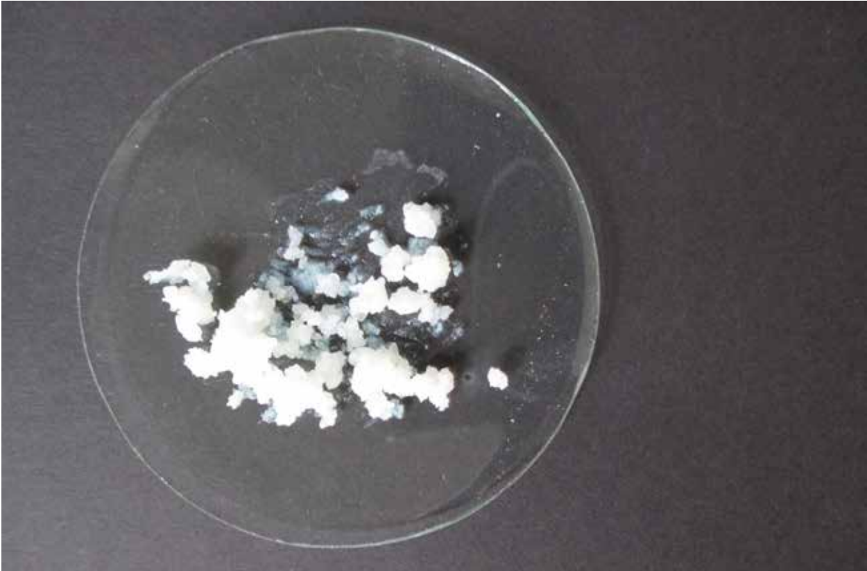
Några droppar utspädd saltsyra tillsatt i kalivattenglas reagerar omgående till en gel, en is-sörjeligkande massa bildas som efter ett tag stelnar till en kristallglittrande torr och fast massa. Foto: Arja Källbom.
