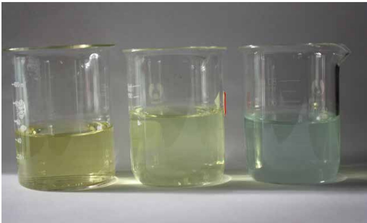
Rena kommersiella kalivattenglas, Purkristalat, AZ Fixativ (svagt grönbå), Rein Mineral. Dessa är färgade, rent vattenglas är ofärgat. De upplevs som vatten i viskositet. I många äldre källor beskrivs vattenglas som sirapslikt i konsistensen, som den späddes vid användning (Kaila, 2007). Foto: Arja Kållbom.
